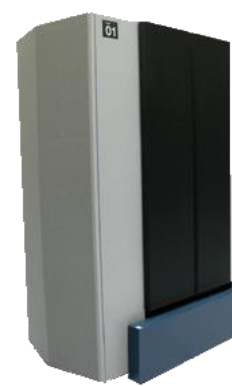
IBM SMP SP2 168 CPU's/ 252Gflops
